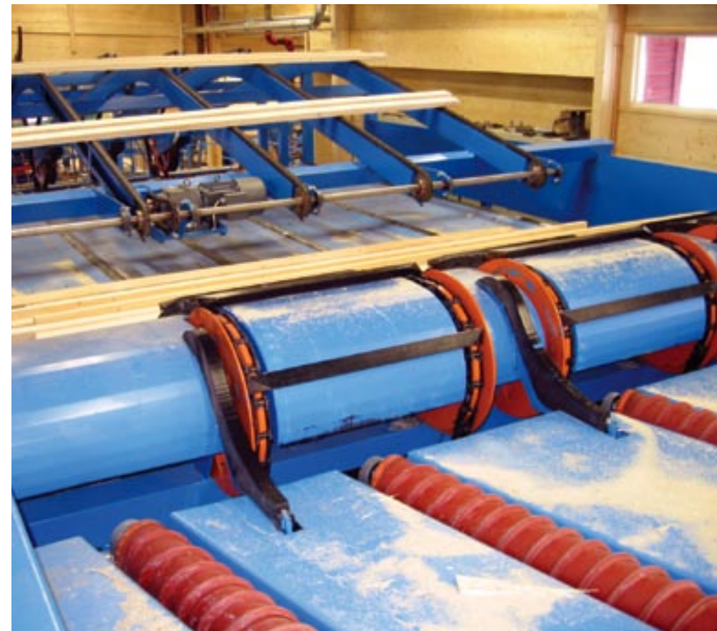
En temporär lösning har skapats för att ta emot virke från den gamla såglinjen till den nya råsörteringen. Efter sommaren ansluts den nya såglinjen.
